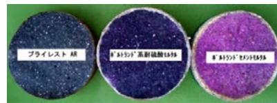
硫酸によるコンクリート腐食が考えられる下水道処理施設内にプライレストAR、ポルトランド系耐硫酸モルタル、ポルトランドセメントの試験片を3年間曝露した結果、プライレストARはポルトランド系の材料より健全性が保たれていた。
