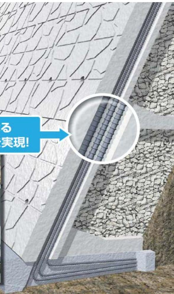
NSSブロックは、ブロック間を鉄筋コンクリートで一体した大型ブロック積擁壁です(道路土工指針準拠)。胴込め部には、従来使用していたコンクリートに代わり、砕石を使用します。NSSブロックは、道路土工指針に従い鉄筋構造をとることで、従来のもたれ式擁壁に比べ、コンクリートボリュームの削減、コスト削減が可能となります。
